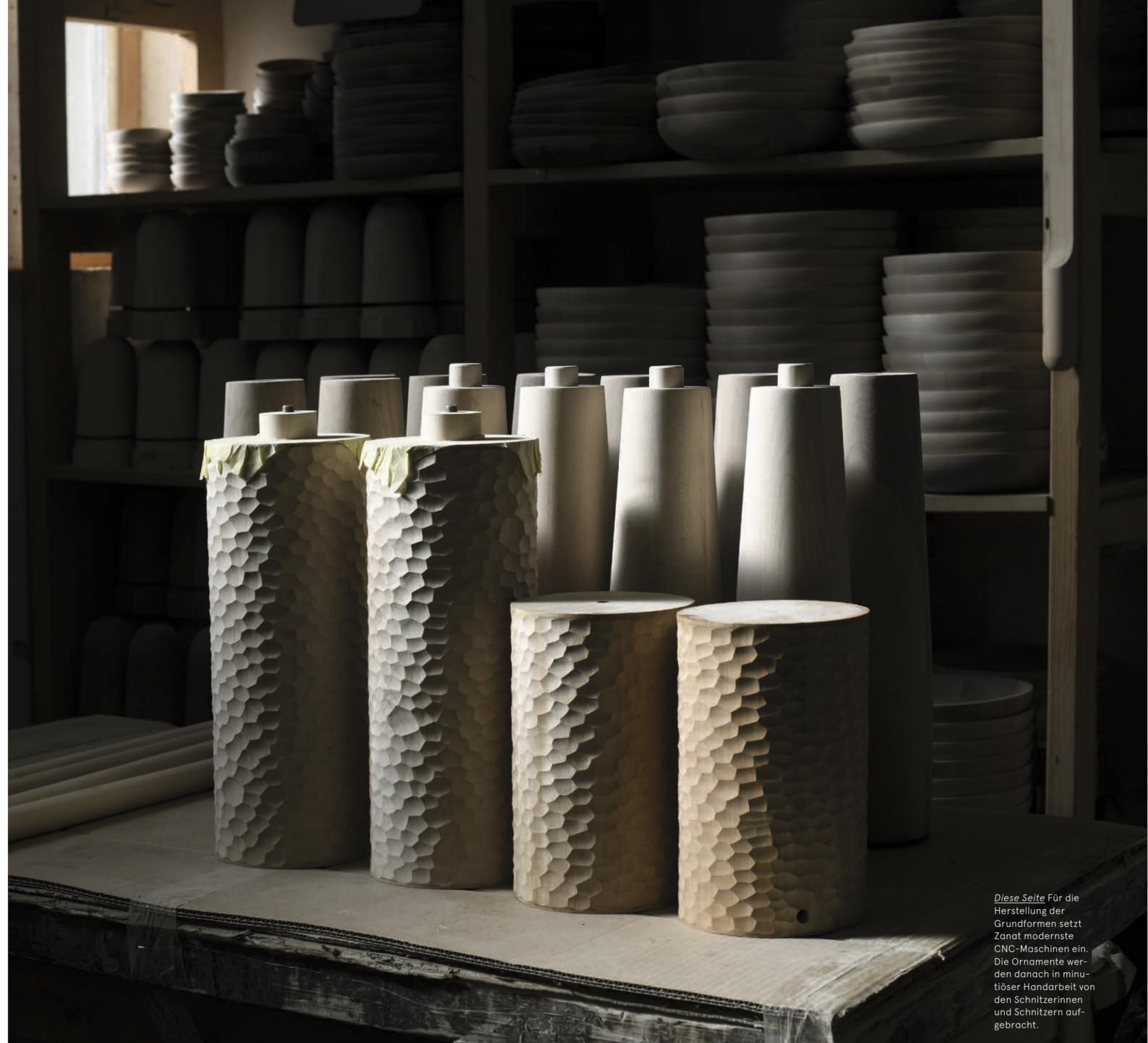
*Diese Seite* Für die Herstellung der Grundformen setzt Zanat modernste CNC-Maschinen ein. Die Ornamente werden danach in minutiöser Handarbeit von den Schnitzern und Schnitzern aufgebracht.
